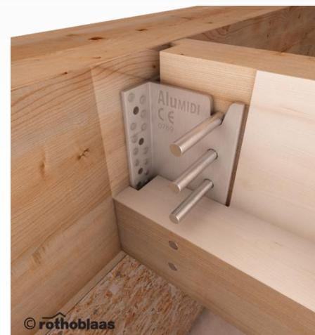
Per il posizionamento di tali staffe è necessario realizzare nella trave secondaria una cava cieca di larghezza pari allo spessore della staffa più 1 mm, mediante macchine a controllo numerico, o apposite cavatrici manuali
